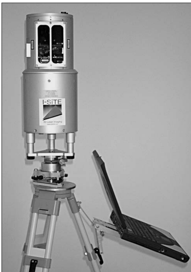
Abb. 2: Meßsystem bestehend aus Laserscanner, Laptop und Software
